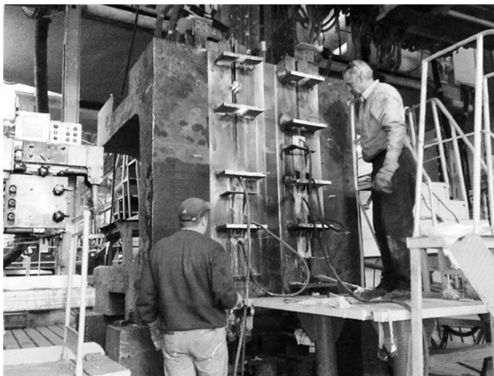
Рис. 3. Рабочий момент ЭШС «протеза» на заводской установке
